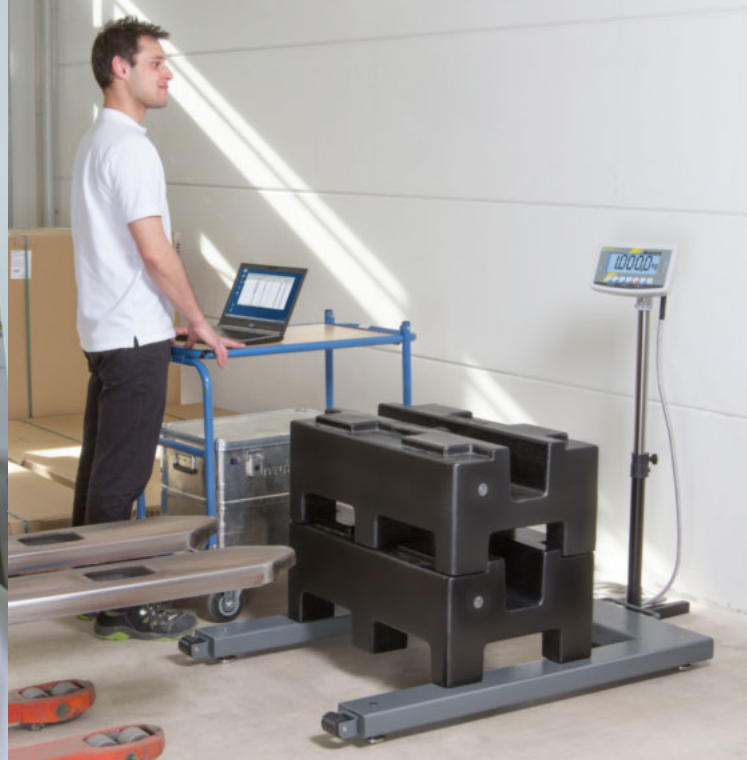
Exakte Messungen vor Ort Bsp: Palettenwaage mit 2 x 500 kg aufgestellt
