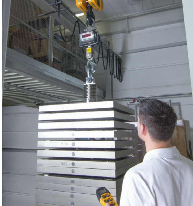
KERN betreibt seit 2014 eine Kranwaagenprüfeinrichtung
